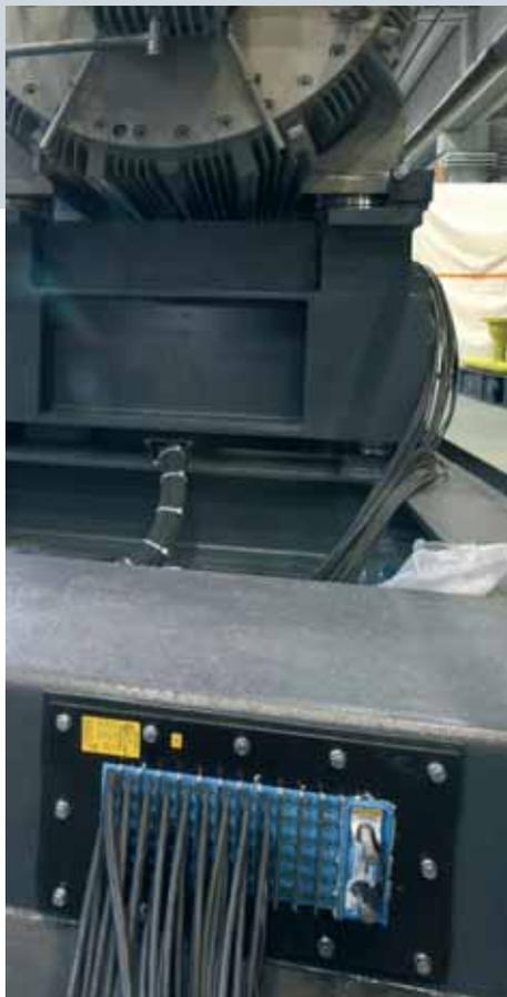
Ein weiteres «kleines» Detail: Alle Kabel werden gasdicht durch den Rahmen der Verdichtergroupe dem Steuerschrank zugeführt.
